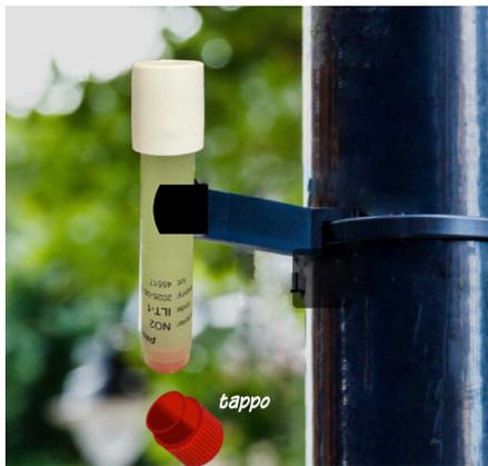
Figura 2 - Il tappo è stato svitato e verrà accuratamente conservato fino al termine (15 dicembre) del campionamento, giorno in cui verrà riavvitato sul tubo.
