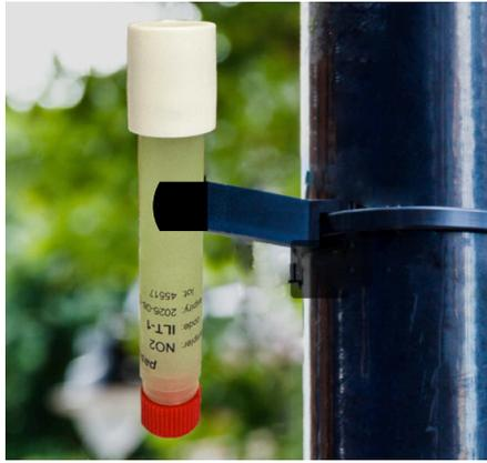
Fig. 1 - Tubo campionatore fissato ad un palo mediante il distanziatore. Il tubo non è stato ancora aperto (il tappo rosso è ancora avvitato al tubo)
